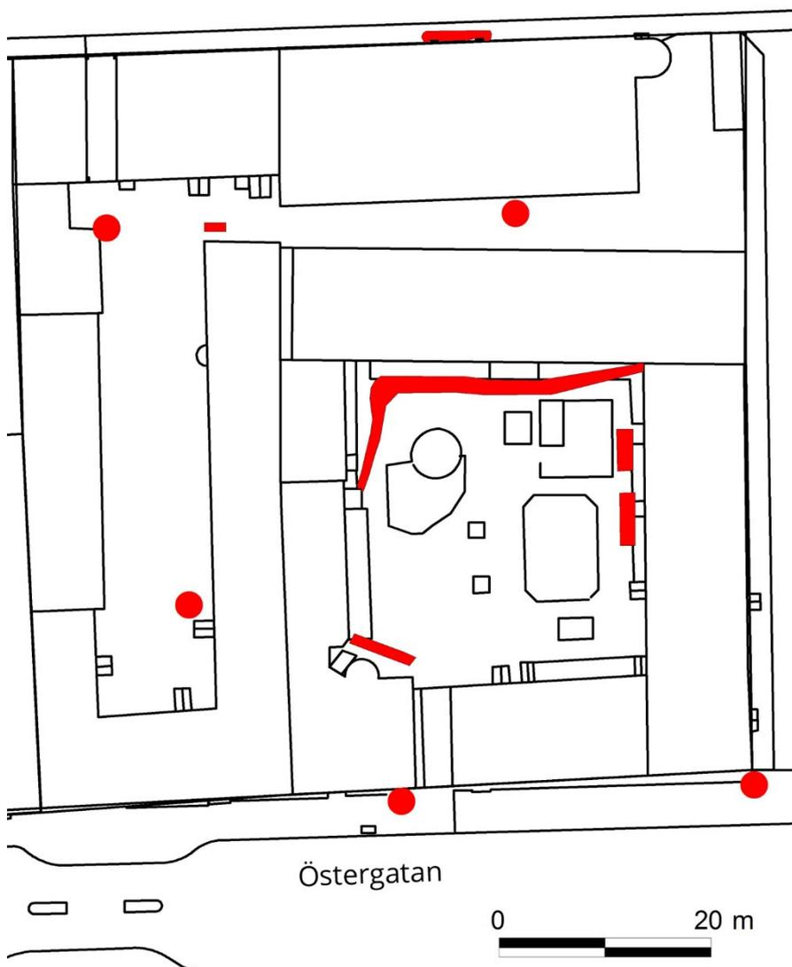
Figur 3. Schaktplan som visar vilka schakt som besiktigades. Röd cirkel innebär att man endast berörde gamla ledningsschakt och schaktets verkliga utsträckning ej mättes in. Schaktet längst i norr och det längre schaktet inne i kvarteret berörde omrörda kulturlager.
