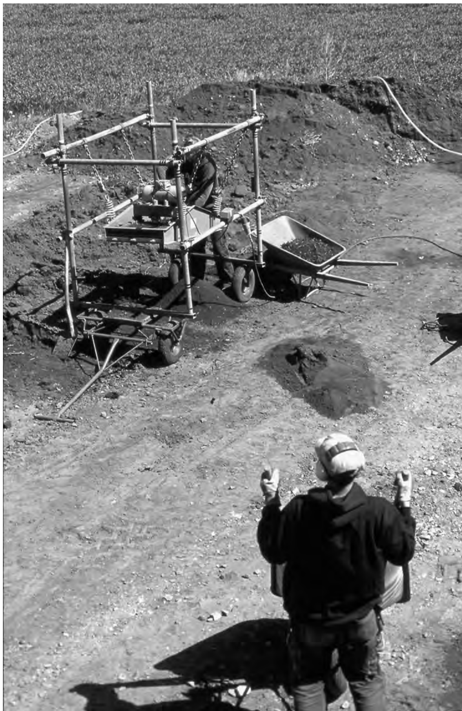
Figur 85. Maskinsällning med ett vibrerande såll. Sållnet kan försees med nät med olika maskstorlekar. Foto: Markus Andersson.
